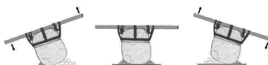
Modo de funcionamiento de un maray
